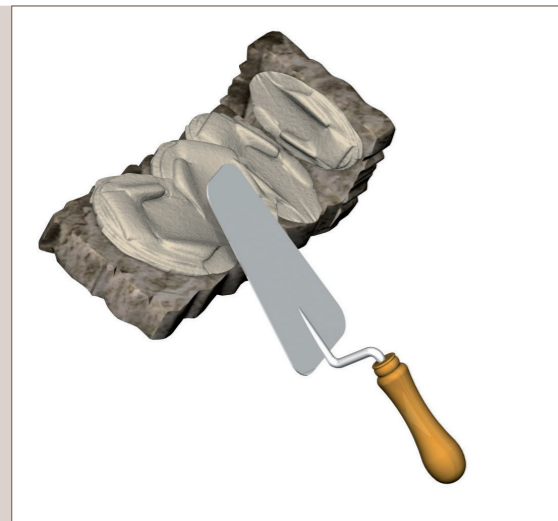
application sur le dos de la pierre à la truelle seulement
