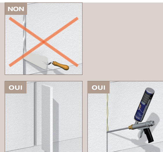
remplissage de joints
