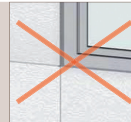
jonctions sur le contour des ouvertures
