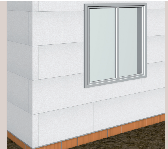
chevauchement des jonctions
